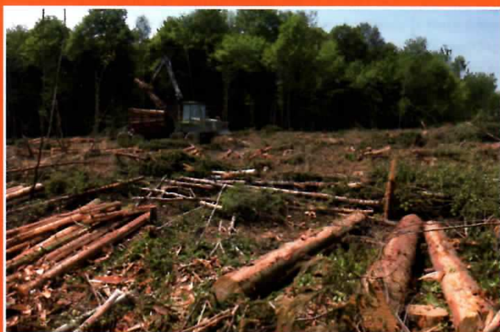
Éclaircissement par bandes à l'aide d'une abatteuse. • Ci-dessous : engin porteur chargeant des billons à destination de papeteries ou de scieries. Les engins sont équipés d'ordinateurs pour effectuer le tronçonnage sur place selon la demande du client.
