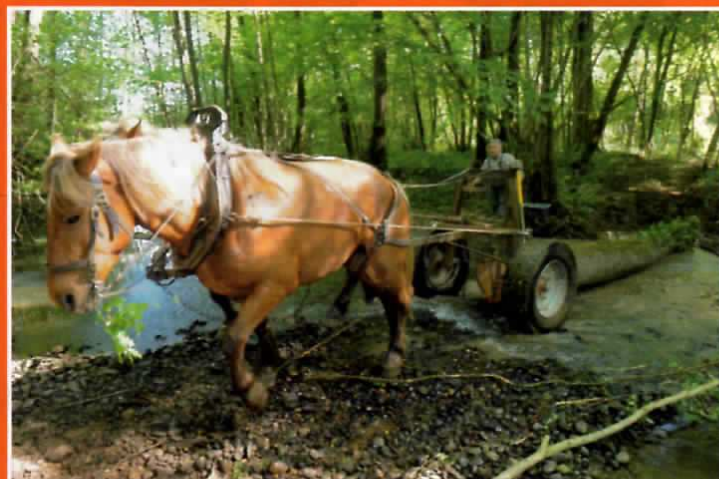
Le débardage à cheval nécessite l'utilisation d'un avant-train, engin qui soulève le bois.
